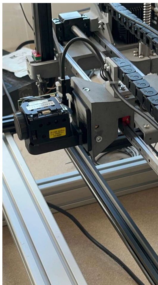
Verfolgungskamera auf der rechten Seite während der Montagearbeiten
